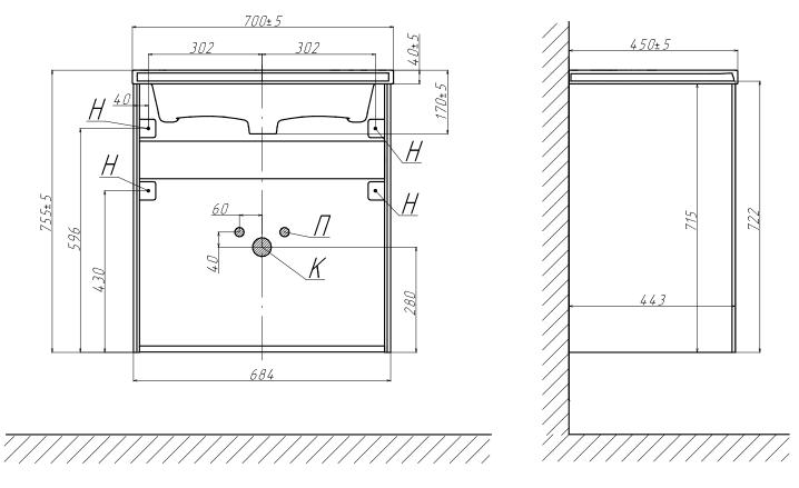
Н – Крепления навесок; П – Подводка воды; К – Вывод канализации
